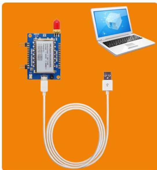
对讲模块USB配置接口连接示意图
