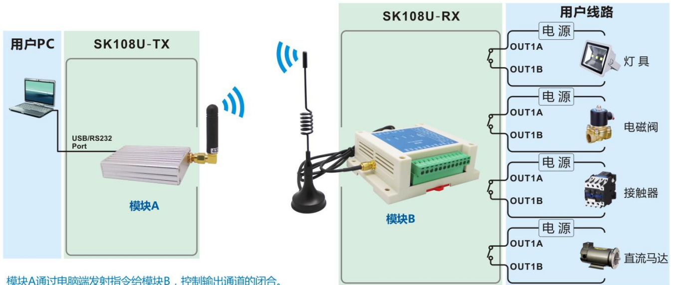
模块A通过电脑端发射指令给模块B，控制输出通道的闭合。
